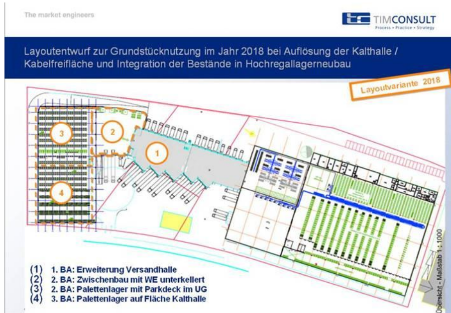
Abb. 4: Layoutentwurf zur Grundstücksnutzung im Jahr 2018 bei Auflösung der Kalthalle / Kabelfreifläche und Integration der Bestände in Hochregallagerneubau
